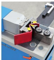
Ohybový nástroj s otočným epem (ohybání bez otisků) pro tlustší plechy. Max 200 x 40 mm.
