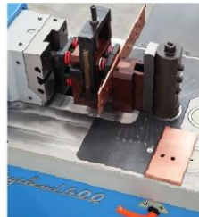
Dílnička do Ø 30 mm. Maximální tloušťka 12 mm.
