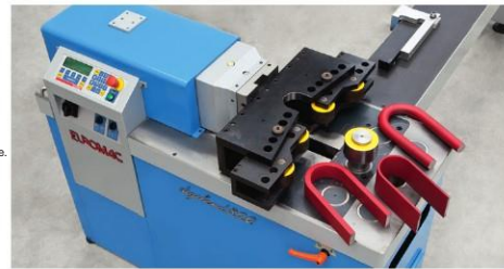
4- elisový ohybový nástroj pro ohybání tyčí a různých profilů. Tyče a silnostní trubky až do 180°. Max 100 x 20 mm nebo Ø 50 mm.
