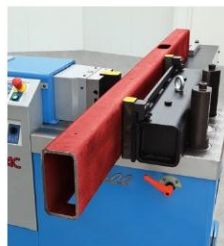
Rovnáčnický nástroj pro trubky, ocelové nosníky, ploché tyče a apod.
