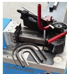
Roleti ohybový nástroj pro potrubí a kulatiny až do 180°. max Ø 50 mm.
