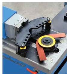
2- elisový ohybový nástroj se sadou pro ploché a tvarované tyče. Max 60 x 20 mm.
