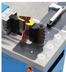
Pohyblivý nástroj s pevnou maticí pro úzké ohyby.
