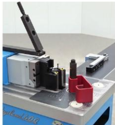
Ohybový nástroj s trnem o Ø 50 mm, H=200 mm, otočná matrice tvaru s zpevněním proti ohnutí. Max. 200 x 8 mm.
