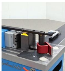
Ohybový trn o Ø 80 mm se zpevněním proti ohnutí. Pro ohybání uzavřených tvarů ze silnostních tyčí. Max 200 x 15 mm.
